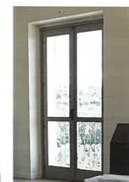
Clima 92 di Alpilegno è un serramento in legno, disponibile in tre finiture, con tre guarnizioni di tenuta e triplo vetro. Trasmittanza termica della sola parte vetrata: U_w 0,6 W/(m^2K) .
