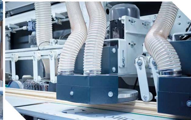
**Il** nuovissimo stabilimento, dotato di impianti produttivi automatizzati di ultima generazione, ospita tutta la filiera del serramento: prima lavorazione automatizzata di piallatura, calibratura e fresatura, incollaggio e levigatura, verniciatura, poi assemblaggio finale, guarnizioni, ferramenta, alluminio, vetri e accoppiamento anta-telaio.
